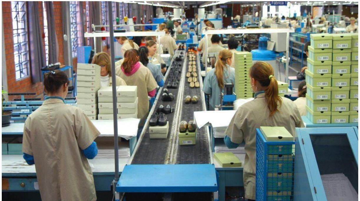
A fabricação celular está em nítido contraste com a abordagem tradicional de fabricação de rota de fábrica, **em que máquinas funcionalmente semelhantes são agrupadas e colocadas próximas umas das outras.**
